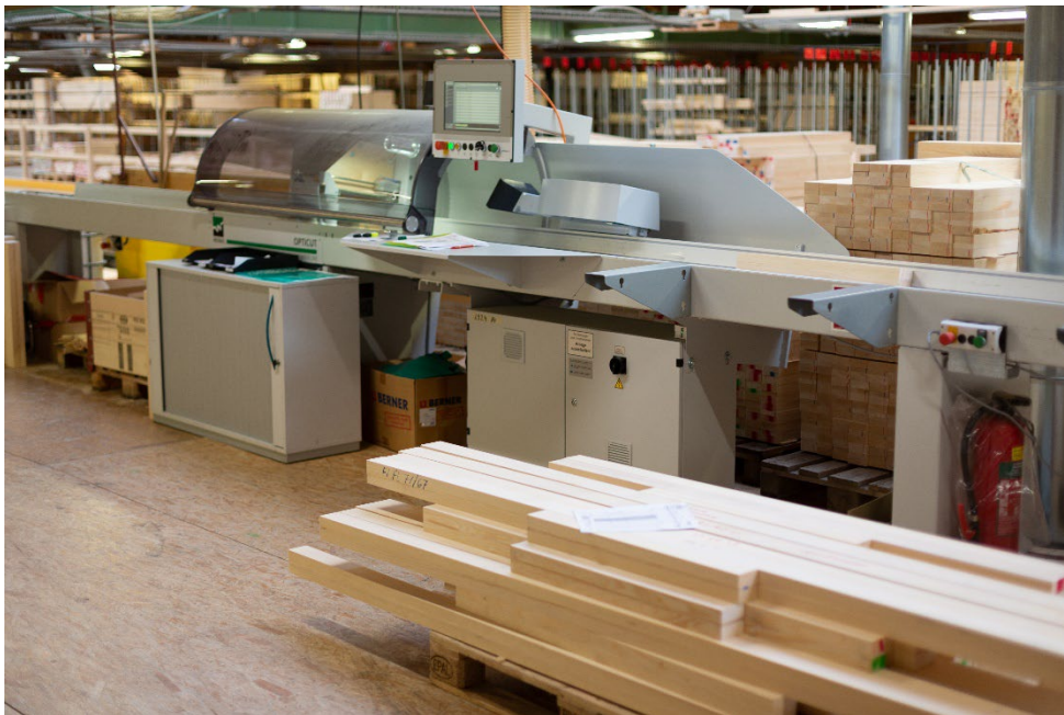
Les nouveaux automates de débitage sont en service.
