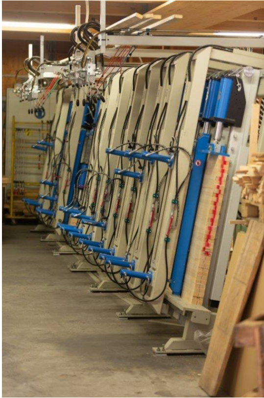
Die Verleimung – ein Kernprozess bei der Herstellung von lamellierten Kanteln.
